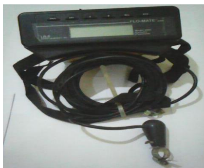
Fig (3): A flow meter
